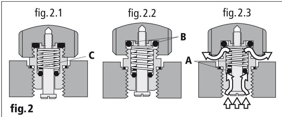
감압이 이루어지는 동안 헬륨 방출 밸브의 용두를 풀어주면 밸브의 기능이 시작됩니다(그림. 2.2). 이때도 방수 기능에는 이상이 생기지 않습니다. 시계 내부의 압력이 외부의 압력보다 높게 되므로 그림에 표시된 A 개스킷을 밀어 내며 시계 내부의 헬륨가스를 방출하게 됩니다(그림. 2.3). 일단 두 압력이 균형을 이루었을 때, C 태엽이 A 개스킷을 밀면서 A 개스킷이 원래 자리를 되찾게 됩니다.(그림. 2.2)
