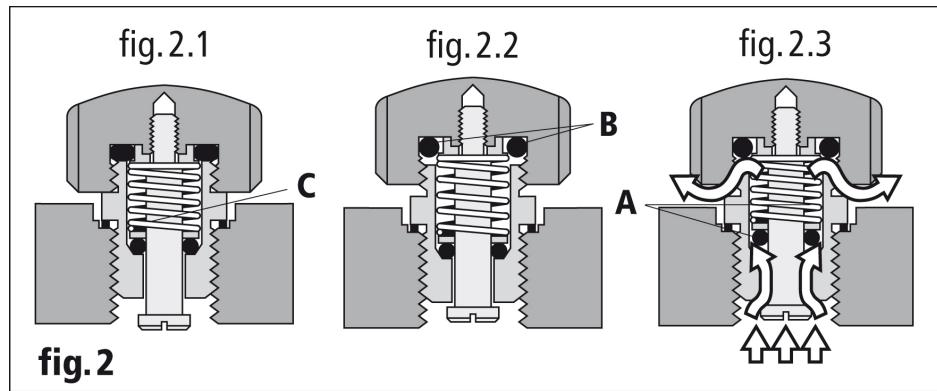
감압이 이루어지는 동안 헬륨 방출 밸브의 용두를 풀어주면 밸브의 기능이 시작됩니다(그림. 2.2). 이때도 방수 기능에는 이상이 생기지 않습니다. 시계 내부의 압력이 외부의 압력보다 높게 되므로 그림에 표시된 A 개스킷을 밀어 내며 시계 내부의 헬륨가스를 방출하게 됩니다(그림. 2.3). 일단 두 압력이 균형을 이루었을 때, C 태엽이 A 개스킷을 밀면서 A 개스킷이 원래 자리를 되찾게 됩니다.(그림. 2.2)
